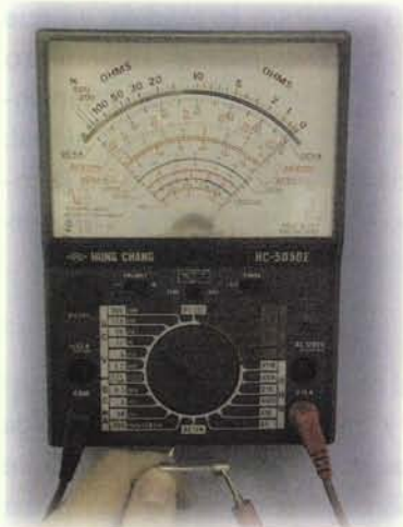
Figura 2.28a. Midiendo continuidad en un fusible. La aguja marca cero ohmios o sea que está bueno
